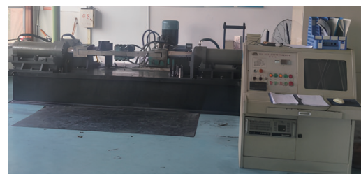
(a) 盘式制动器摩擦试验台实物图
