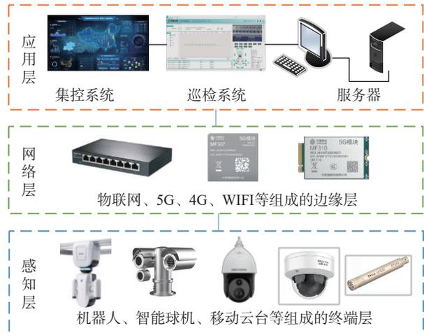
图 1 机器人巡检系统平台架构
