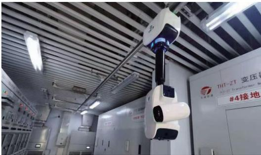
图 11 35 kV 开关室巡检机器人
