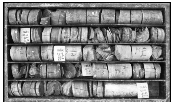
图3 钻孔中所揭露的泥岩、页岩板岩化
