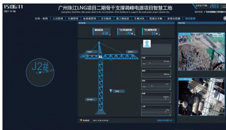
图 1 智慧工地-塔吊监测页面
