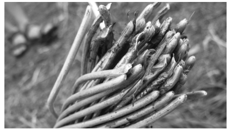
图7 导线断口形状
