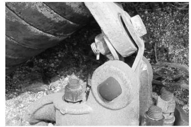
图 2 #237 塔 U 型挂板变形
