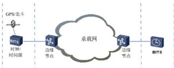
图 3 电力时间同步网逻辑图
