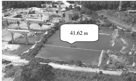
图 6 在建高速公路与已建输电线路的空间距离量测
