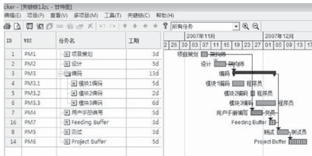
图 2 使用关键链方法编制的计划 Fig. 2 Schedule Base on CCPM
