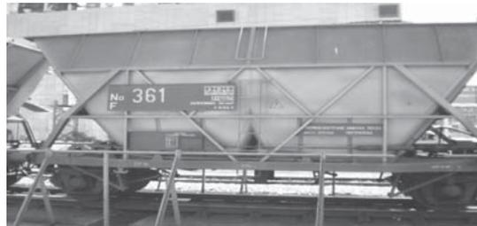
图 2 塞尔维亚奥布雷诺瓦茨电厂底开车车型
