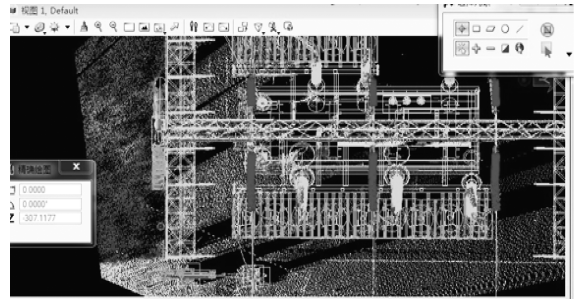
图 6 变电站设备点云数据
