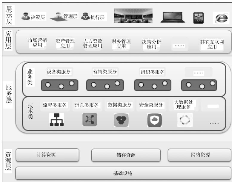
图 2 电网企业去系统化的 IT 架构
