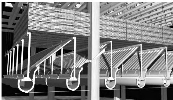
图3 高位收水装置示意图
