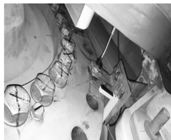
图 6 第二次改造光电、电磁传感器混合使用示意图
