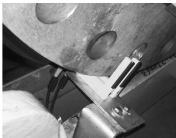
图 5 第一次改造光电传感器安装示意图
