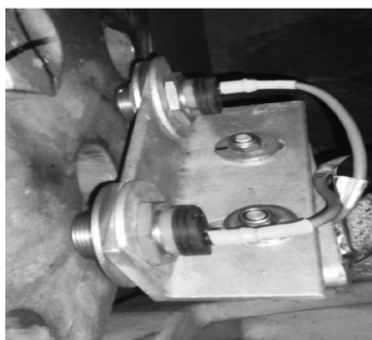
图 4 电磁感应转速传感器与叶轮锁盘安装间隙示意图
