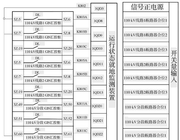
图 6 就地采集装置的电气原理图
