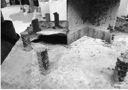
图 3 A 类试件的拔出破坏
