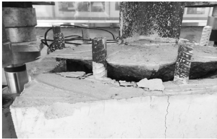
图 5 C 类试件的冲切破坏
