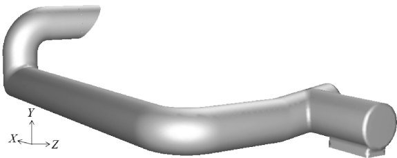
图 3 小机排汽管道三维模型图
