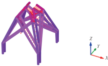
图 13 大圆筒组合导管架海上风机基础结构三维有限元模型上部导管架水平变位
