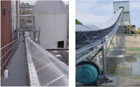
图3 国外悬浮带式输送机应用实例
