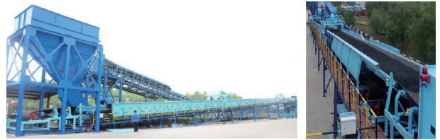
图4 大运量悬浮带式输送机样机照片
