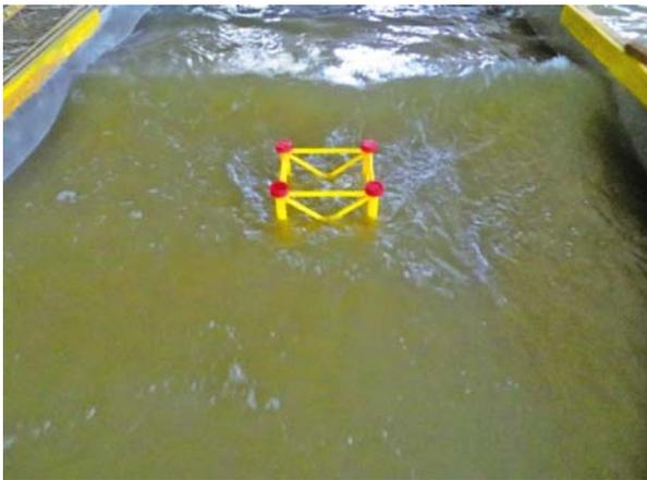
图 4 升压站导管架模型受极端高水位 + 波流作用
