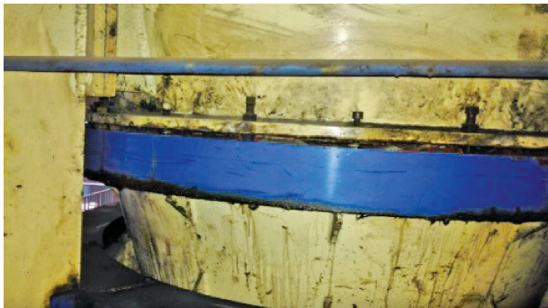
图 2 旋转清堵机密封处漏油
