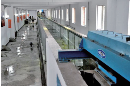
图3 无反射不规则波造波机试验水槽
