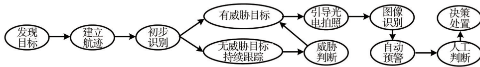
图7 光电摄像头和雷达的联动流程
