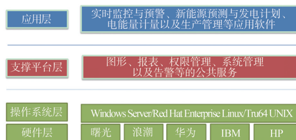
图2 风光储多能互补电源集控系统结构示意图
