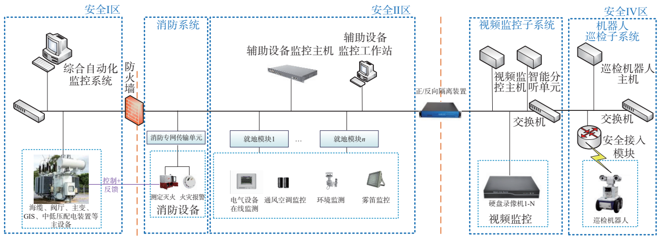
图1 海上换流站智能辅助控制系统结构示意图
