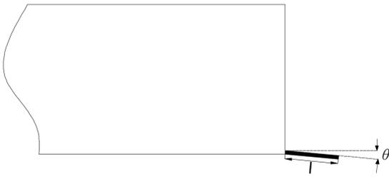
图8 压浪板示意图
