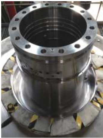
图3 密封室 Fig. 3 Seal housing
