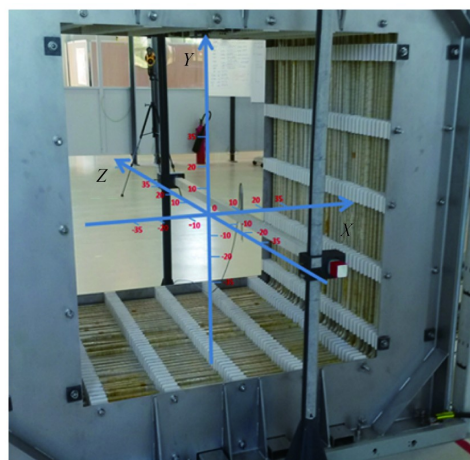
(b) 法国 SCLC 研制的设备: 磁场均匀区域 0.7\text{ m} \times 0.7\text{ m} \times 0.7\text{ m} , 最大 250 mT。
