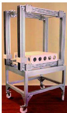
(c) 西班牙 Applus 研制设备: 磁场均匀性区域 0.6\text{ m} \times 0.6\text{ m} \times 0.6\text{ m} , 最大 12.5 mT。
