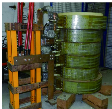
(a) 法国 CEA 研制的设备: 磁场均匀区域 0.35\text{ m} \times 0.35\text{ m} \times 0.35\text{ m} , 最大 480 mT。
