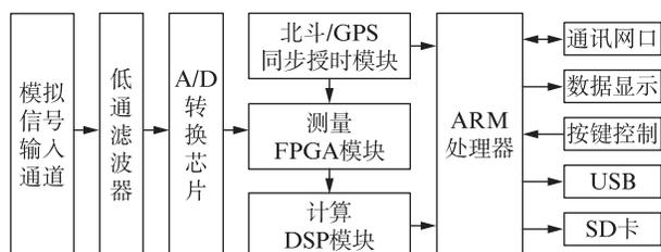
图4 同步相量测量终端架构框图
