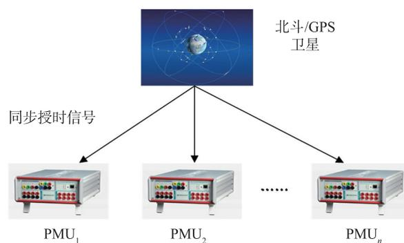
图 3 同步相量测量授时原理
