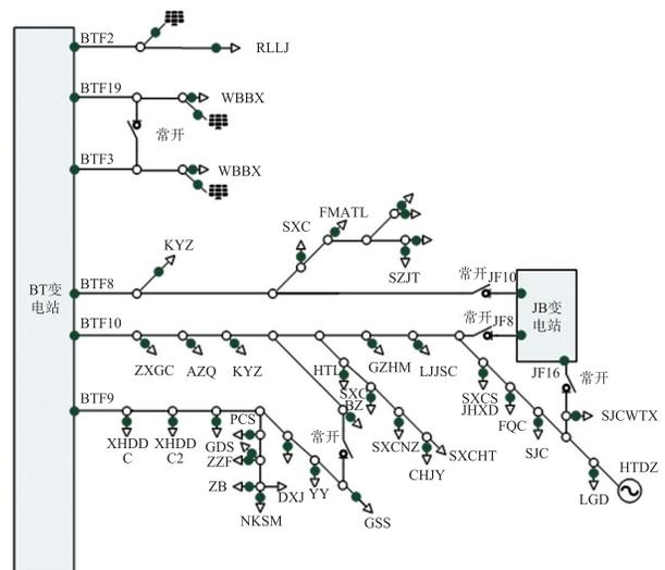
图6 示范工程同步相量监测安装点
