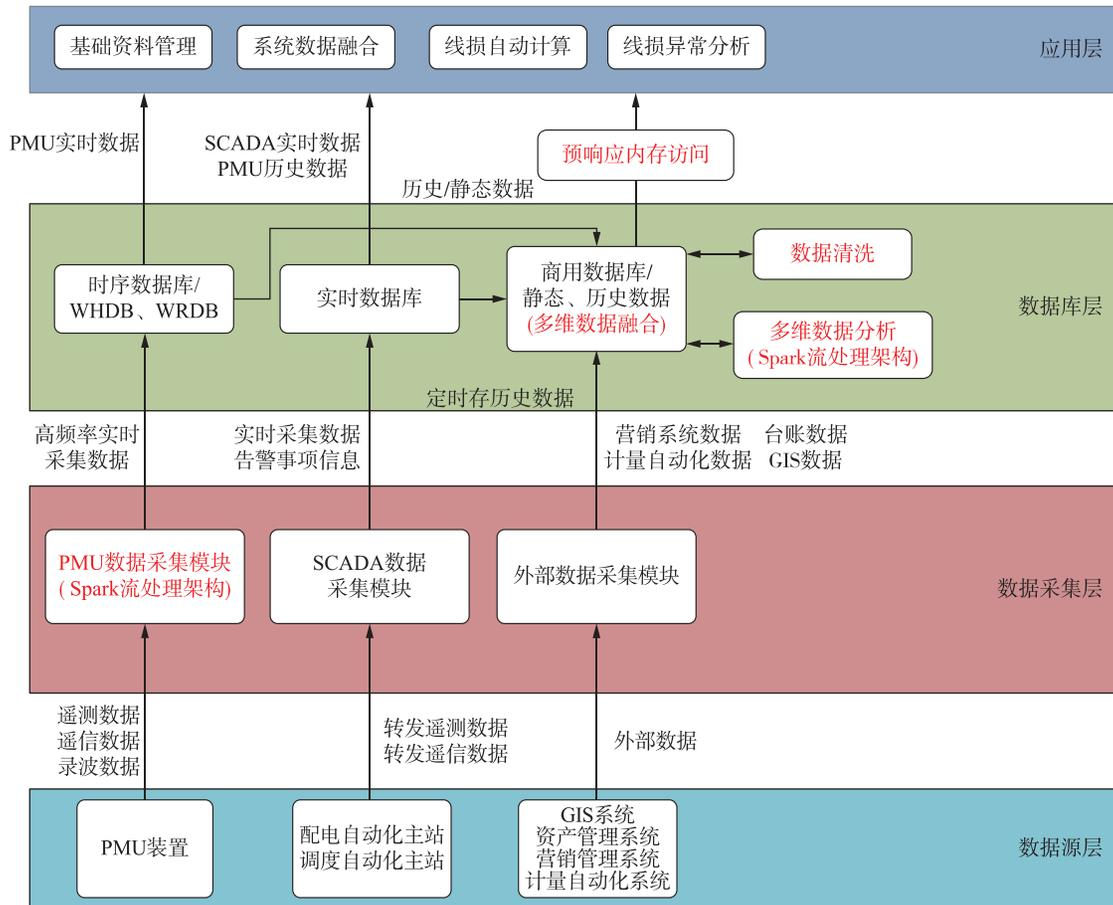
图 8 线损实时同步分析平台架构设计
