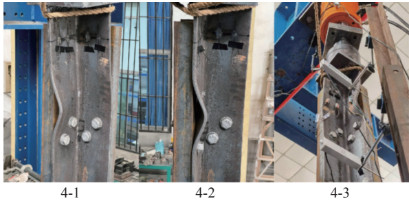
图 4 试件 4 局部屈曲破坏
