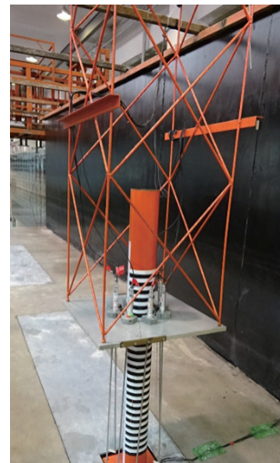
图 5 浪高仪卡盘安装位置
