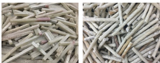
图 5 风机叶片切割加工成的针状元件
