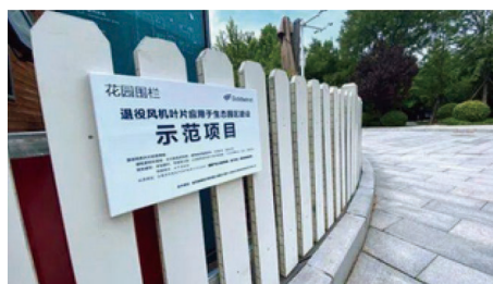
图 7 使用废旧风机叶片固废 3D 打印的园区景观
