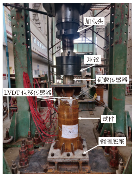
图 4 轴向静力加载装置示意图
