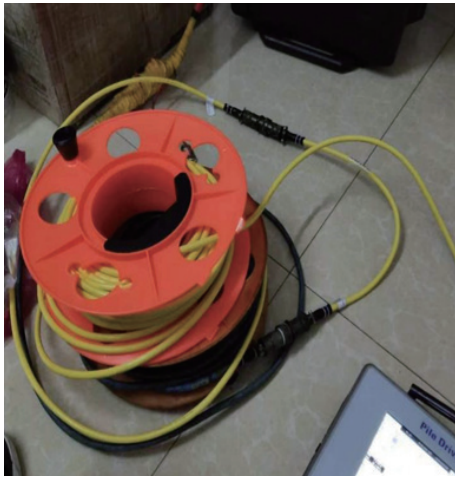
图 4 高应变数据采集线缆及终端照片
