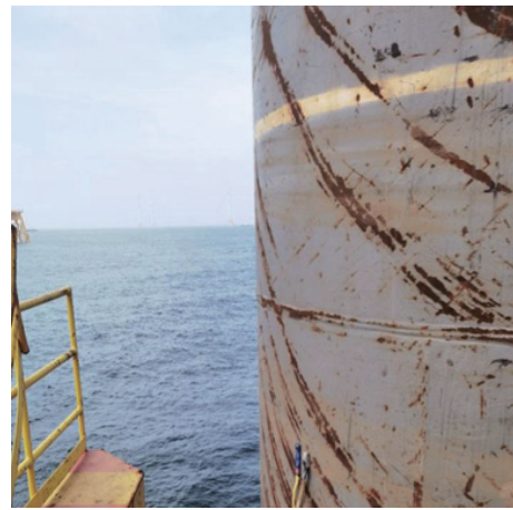
图 3 高应变测量桩身设置照片
