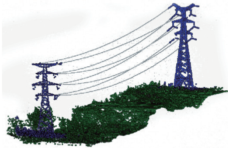
图3 低精度点云结合矢量化电力线展示图
