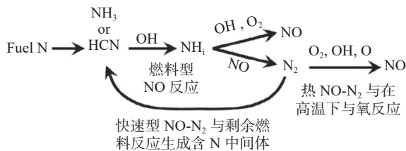
图 7 \text{NO}_x 形成机制的简化示意图 [10]
