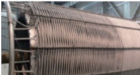
(a) 水浴式气化器的内胆结构
