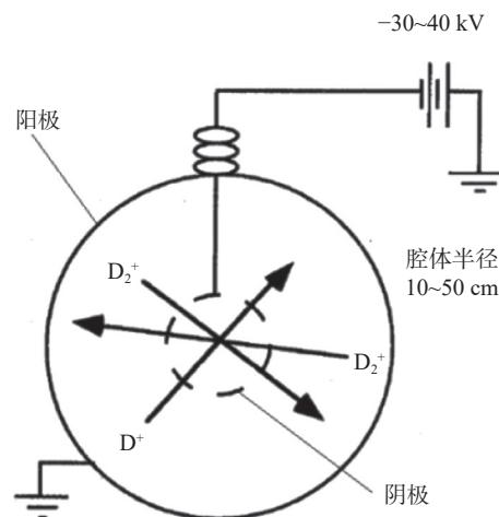
图 1 IEC 装置原理图
