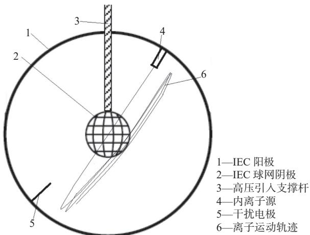
图 3 内离子源注入的 IEC 装置原理图
