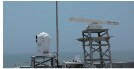
图 4 雷达光电系统安装示意图
