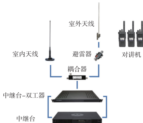
图 6 UHF 集群对讲系统组成示意图
