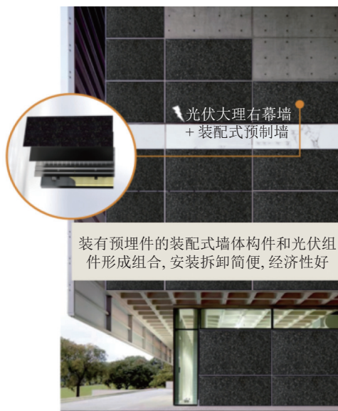
图6 装有预埋件的装配式墙体构件和光伏大理石组件形成组合
