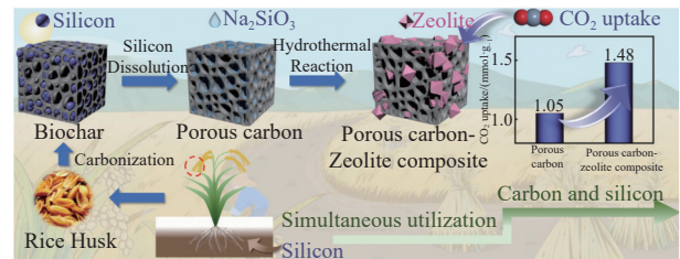
图 2 富硅稻壳制备多孔炭-沸石复合材料 [36]
