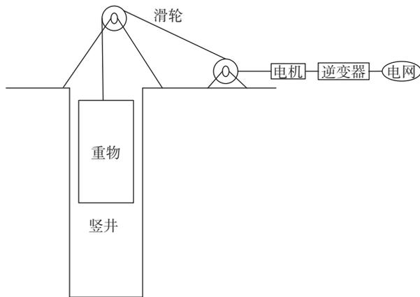
图1 竖井式重力储能装置示意图
